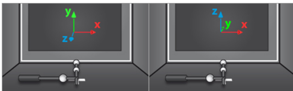
Figure 39 : Orientations Y UP (à gauche) et Z UP (à droite).
