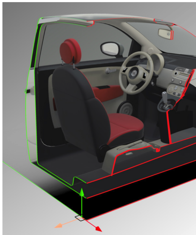
Figure 14 : 断面が2つのクリップ平面の例
