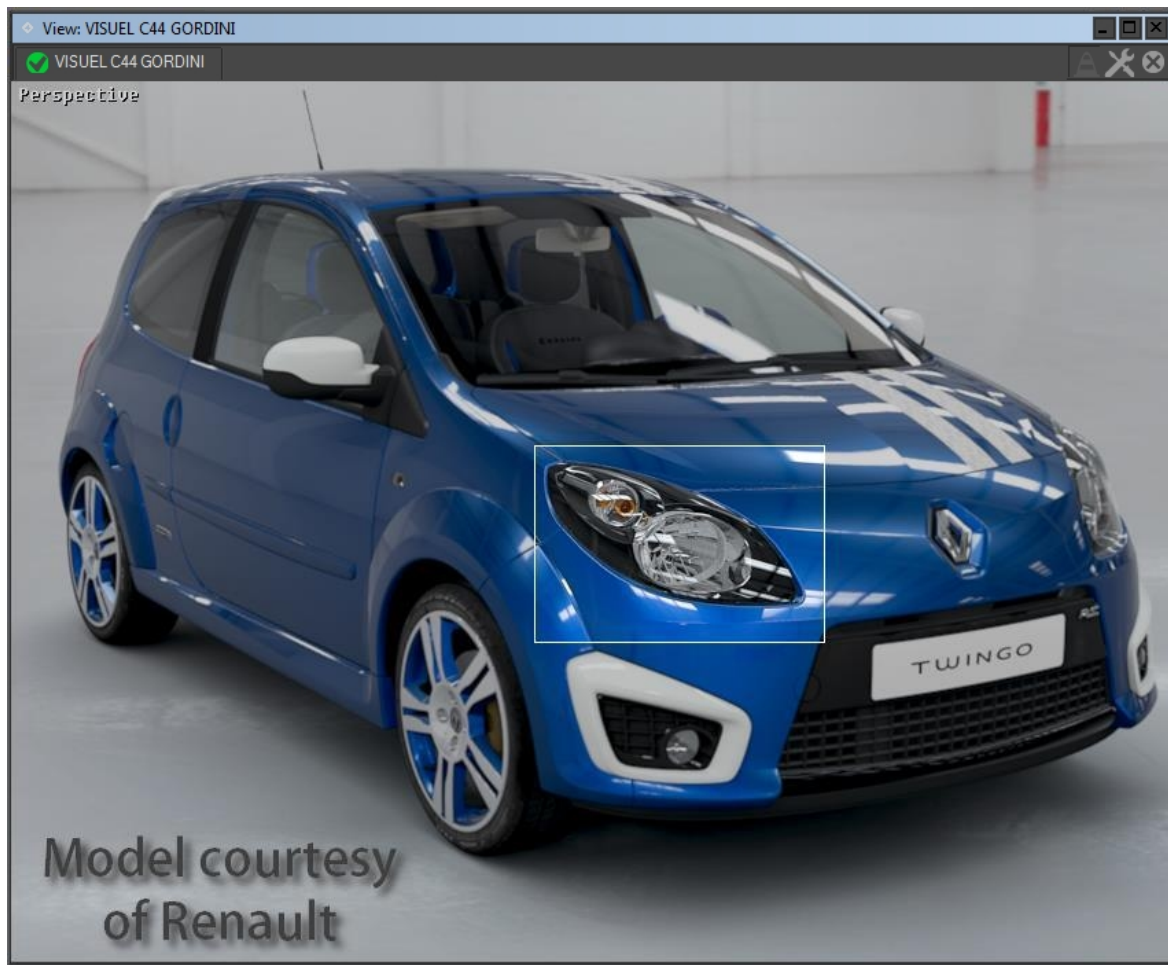
ビューの領域に制限されたレイトレーシングレンダリング。
