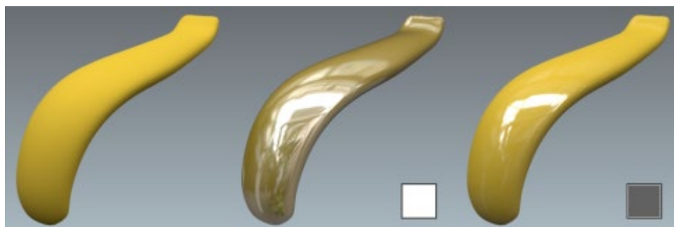
修正漫反射和反射类标准材质的亮度。从左到右：漫反射层；漫反射层+反射层无滤光片（白色滤光片）；漫反射层+灰色滤光片反射层。
