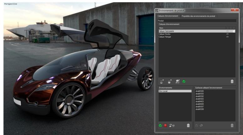
Figure 179 : Résultat de l'évaluation de la pile de calques d'environnement.
